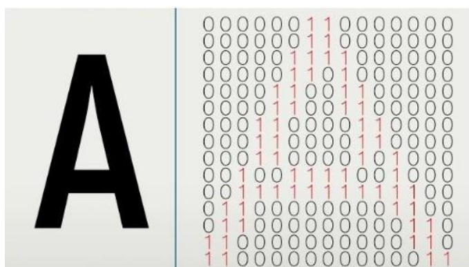
Figura 5 - À esquerda, caractere “A” impresso em tipografia. À direita, reconhecimento do caractere “A” em formato OCR.
